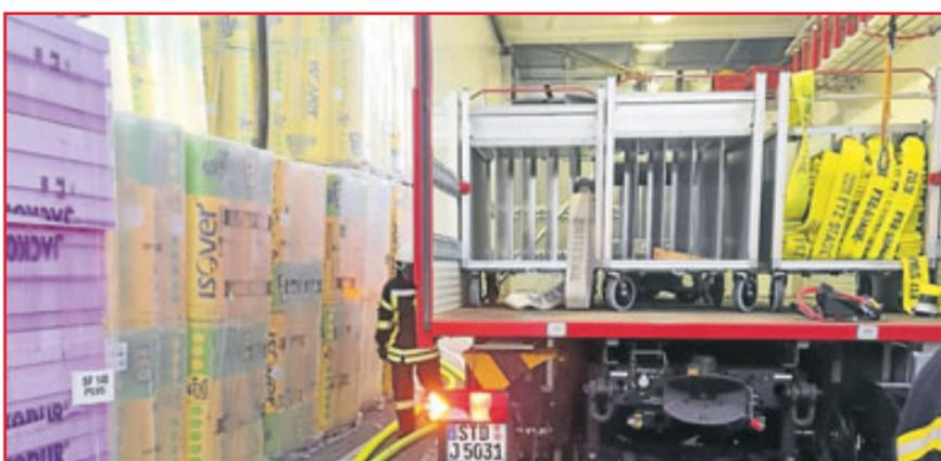
Der Schlauchwagen nach dem Verlegen von Leitungen bei einem Großbrand in Harsefeld. Zu sehen sind die leeren Rollcontainer auf der Ladefläche.
