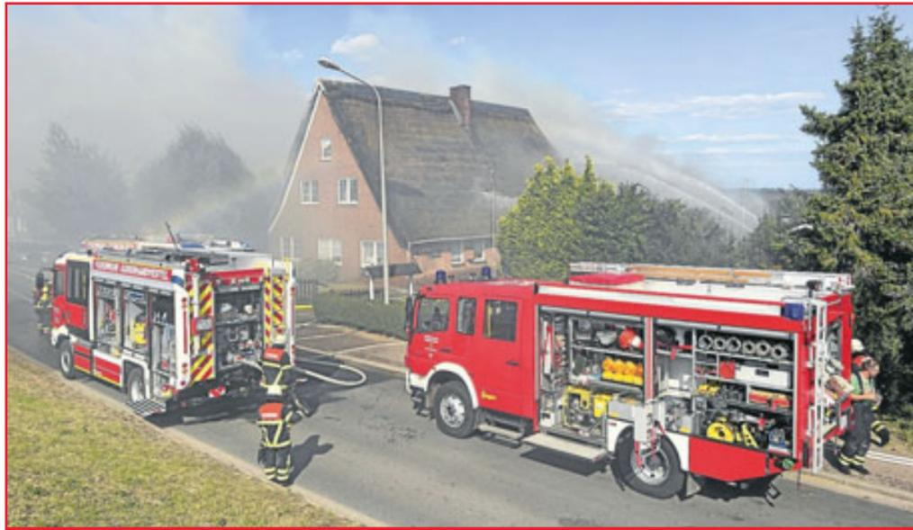
Wind trägt Funken von Bränden weit durch die Luft, und das transportierte Feuer kann andere Reetdächer dann in Brand setzen. Um das zu verhindern, werden besonders gefährdete Gebäude bei Feuer in der Nachbarschaft provisorisch mit Wasser besprüht, wie dieses Foto zeigt.
