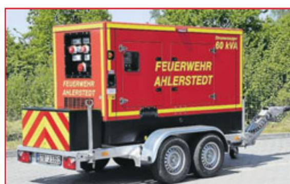
Um bei längerem Stromausfall Gerätehäuser mit Elektrizität zu versorgen, sind diese mobilen Aggregate gedacht.
