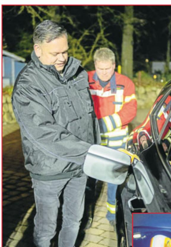
Hier demonstriert Ulrich Tietjen, wie der Emergency-Plug funktioniert: Einfach in die Ladebuchse gesteckt, simuliert er einen Ladegang, was sofort dazu führt, dass das E-Auto auf die Fahrstufe „P“ schaltet und die elektrische Parkbremse anzieht. Danach ist es den Einsatzkräften möglich, gefahrlos am Fahrzeug zu arbeiten, das nicht mehr unbeabsichtigt anfahren kann.
