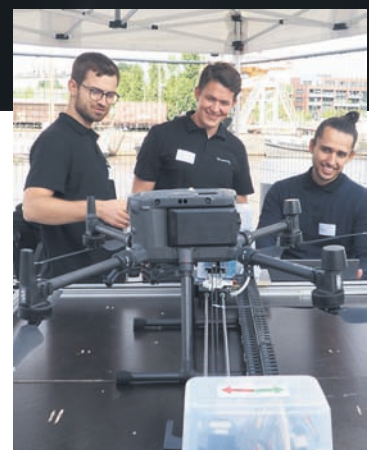
Auf dieser Landeplattform kann eine Inspektionsdrohne vollautomatisch die Akkus tauschen.
