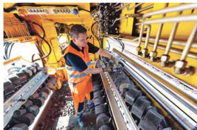
Blick ins Schleifaggregat: Hier werden die Schleifsteine getauscht.
