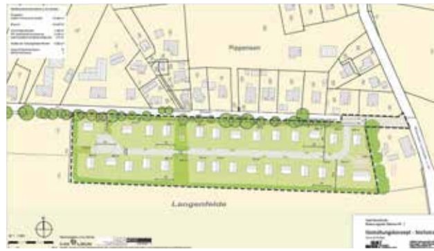
Gut zu erkennen: Um die Baumreihe an der Heimbrucher Straße in Pippensen nicht zu gefährden, wird die Baufläche über eine neue, parallel verlaufende Straße erschlossen.
