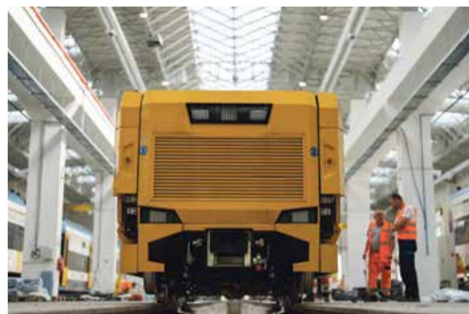
Made in Harburg: die kleine Schienenschleifmaschine VTM-compact zur Wiederherstellung gesunder Schienen bei schwerer Oberflächenschädigung.
